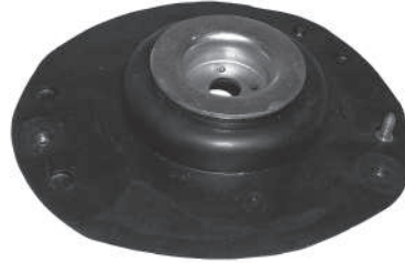
Código: 60080 I Modelo: PEUGEOT 206 Nº Original: 5038-360 Cazoleta de amortiguador izquierdo
