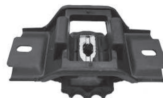
Código: 70223 Modelo: ECOSPORT 4X2 Y 4X4 Nº Original: 2S65-7M121-AB Soporte de motor izquierdo
