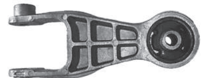
Código: 40061 Modelo: CORSA II - MERIVA Nº Original: 93302287 Soporte tensor inferior
