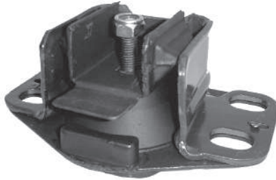
Código: 80146 NO HIDRAULICO Modelo: KANGOO Nº Original: 7700434320 Soporte de motor derecho (no hidráulico)
