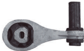
Código: 50195 Modelo: PUNTO 1.8 Nº Original: 51795195 Soporte tensor de motor
