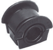
Código: 50136 Modelo: FIAT PALIO - SIENA Nº Original: 46465901 Buje barra estabilizadora ø 20 mm
