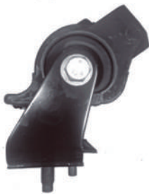
Código: 70214 Modelo: RANGER 4X2 2012.. Nº Original: AB39-6B032-EF Soporte de motor izquierdo
