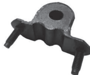
Código: 50166 Modelo: PALIO - SIENA Nº Original: 51744226 Buje barra estabilizadora
