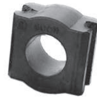
Código: 60011 Modelo: P. 504 2000 Nº Original: 5094-011 Buje barra estabilizadora ø grande
