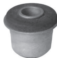
Código: 30009 Modelo: HILUX 4X4 SR5 Nº Original: 48632-260107 Buje parrilla superior ant. chico ø 20 mm
